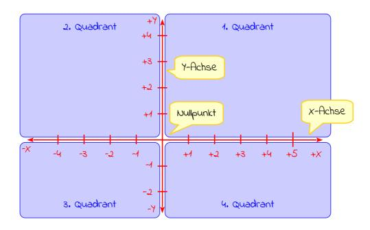
Diese beiden Achsen (X-Achse und Y-Achse) stehen in einem rechten Winkel aufeinander und bilden ein "Gitternetz", das Koordinatensystem genannt wird. In der Mitte jedes Koordinaten-
