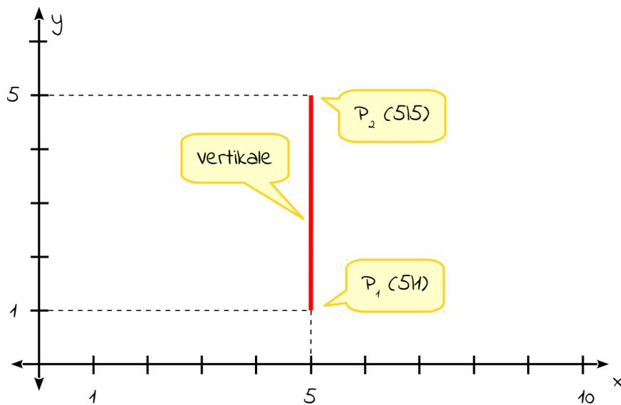
Die Vertikale ist eine Gerade, die zwei auf gleicher X-Richtung liegende Punkte verbindet.
